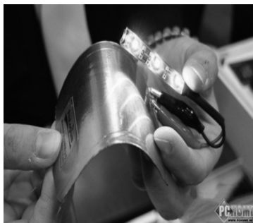
图2 柔性锂离子电池示意图
